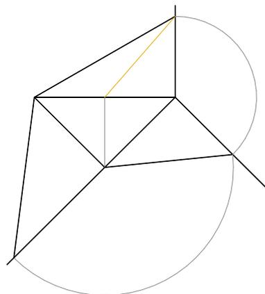
Posizionare la base ABCD della piramide appoggiandola sul piano orizzontale e facendola ruotare genericamente rispetto al proprio asse in modo tale da non avere punti di coincidenza nelle proiezioni sui piani principali.
