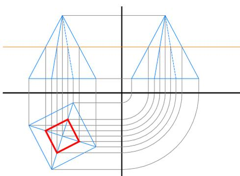
La proiezione sul piano orizzontale, data la posizione del piano secante, determina una sezione simile per forma, ma inferiore per dimensione, alla base della piramide.
