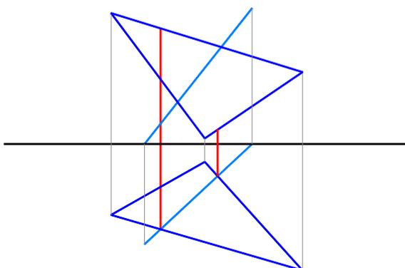
Per individuare il punto nel triangolo si ipotizza un piano secante ausiliario  $\alpha$ , passante per la retta e ortogonale al piano orizzontale. Tracciato quindi il piano  $\alpha$  passante per  $r$  e determinato il segmento sezione del triangolo sul piano orizzontale, proiettare gli estremi sul piano verticale.
