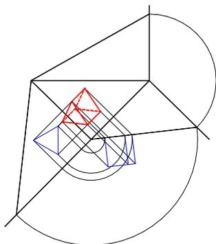
Dalla proiezione sul piano  $\beta$  ortogonalmente alla  $T^1\beta$  e la proiezione sul piano  $\alpha$  ortogonalmente alla  $T^1\alpha$ , si determina la prima proiezione del prisma. Per l'individuazione delle parti nascoste si consideri che essendo ABC la base coincidente con il piano  $\alpha$  sarà a partire da essa che si dovranno individuare all'interno del contorno della figura le parti non direttamente individuate dai raggi proiettanti.
