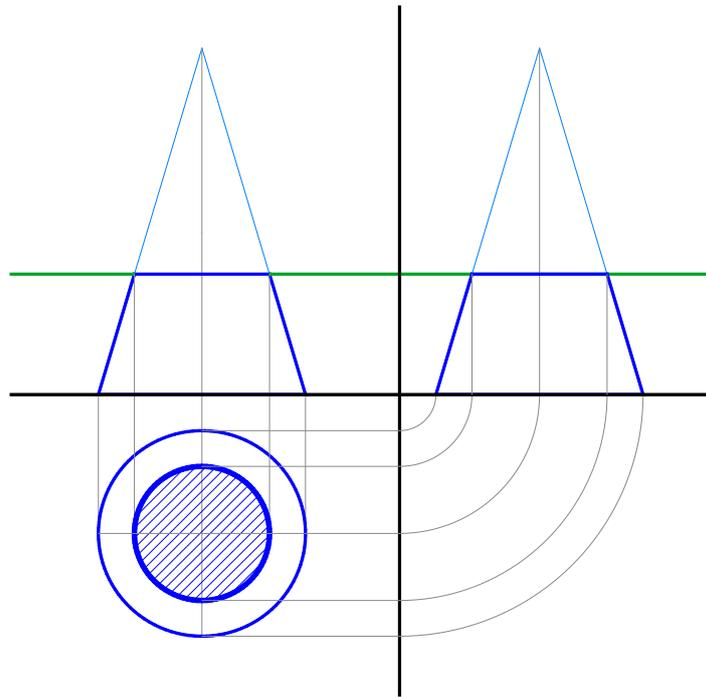
**Sezione di un cono con piano secante ortogonale al suo asse**
