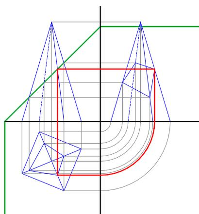
Il contorno della sezione sul PO sarà dato dall'intersezione dei raggi proiettanti passanti 1-2-3-4, con la proiezione della piramide. Analogamente si procederà per il contorno della sezione sul PL proiettando anche in questo caso i punti 1-2-3-4. Determinare le proiezioni dei punti collegando raggi ortogonali sul PO, PV e PL. Data la posizione della piramide e inclinazione del piano secante, le immagini delle proiezioni della sezione risulteranno dei quadrilateri irregolari.
