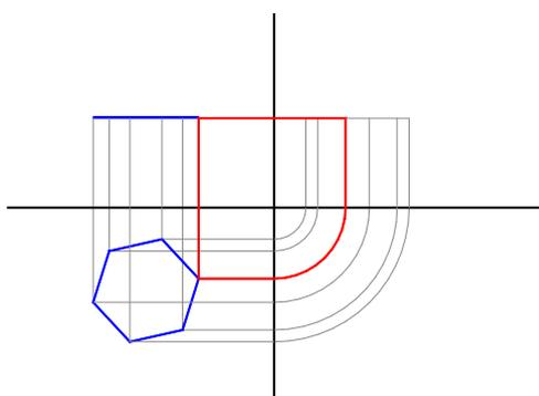
Tracciare l'esagono sul PO nella forma e misure reali poiché parallelo al piano di proiezione e ruotato di un angolo generico in modo tale da non far coincidere fra loro alcun punto nella proiezione sui piani verticale e laterale. L'esagono in condizione di parallelismo rispetto al piano orizzontale sarà rappresentato in vera forma, mantenendo inalterate le misure lineari e angolari.
