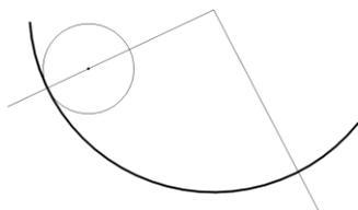
Tracciare la circonferenza deferente di centro C e raggio  $R_d = AC$ . Tracciare la retta passante per AC. Impostare la circonferenza generatrice di centro  $O_0$  appartenente a AC e raggio  $R_g = O_0 A$ . Individuare sulla deferente l'arco ACA, compreso nell'angolo  $\alpha$ , riportando la misura della circonferenza generatrice attraverso la formula:
