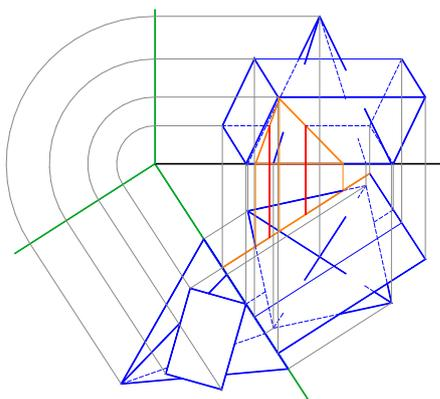
Una volta determinati tutti i singoli punti di intersezione, la rappresentazione si completa unendoli tenendo conto in particolare della contiguità e vicinanza e soprattutto dell'appartenenza al medesimo piano. Dal punto di vista grafico è opportuno ripassare con segno di linea continua le parti a vista e tratteggiare quelle nascoste, mentre è preferibile non rimarcare se non con segno di costruzione le parti interne dei solidi.
