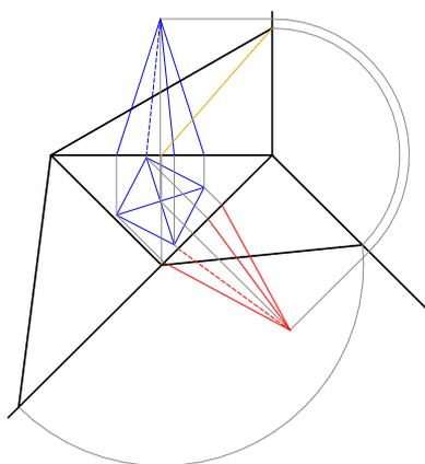
Proiettare la piramide ortogonalmente alla  $T^\beta$  sul piano ausiliario  $\beta$  e determinare i punti di sezione 1, 2, 3 e 4 rispettivamente sugli spigoli AV, BV, CV e DV, nell'intersezione della proiezione del solido con la  $T^\alpha$  traccia del piano secante  $\alpha$  ( $N'M^\beta$ ) sul piano ausiliario  $\beta$ .
