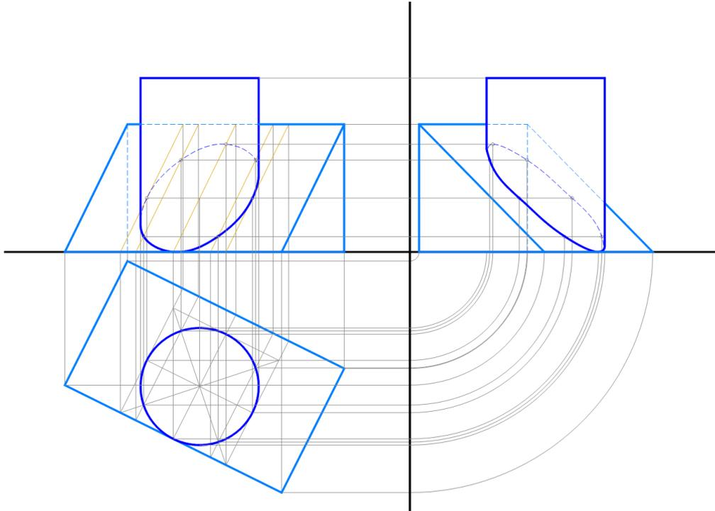
**Compenetrazione di un prisma a base triangolare con una faccia laterale appoggiata al piano orizzontale e un cilindro con asse ortogonale al piano orizzontale**
