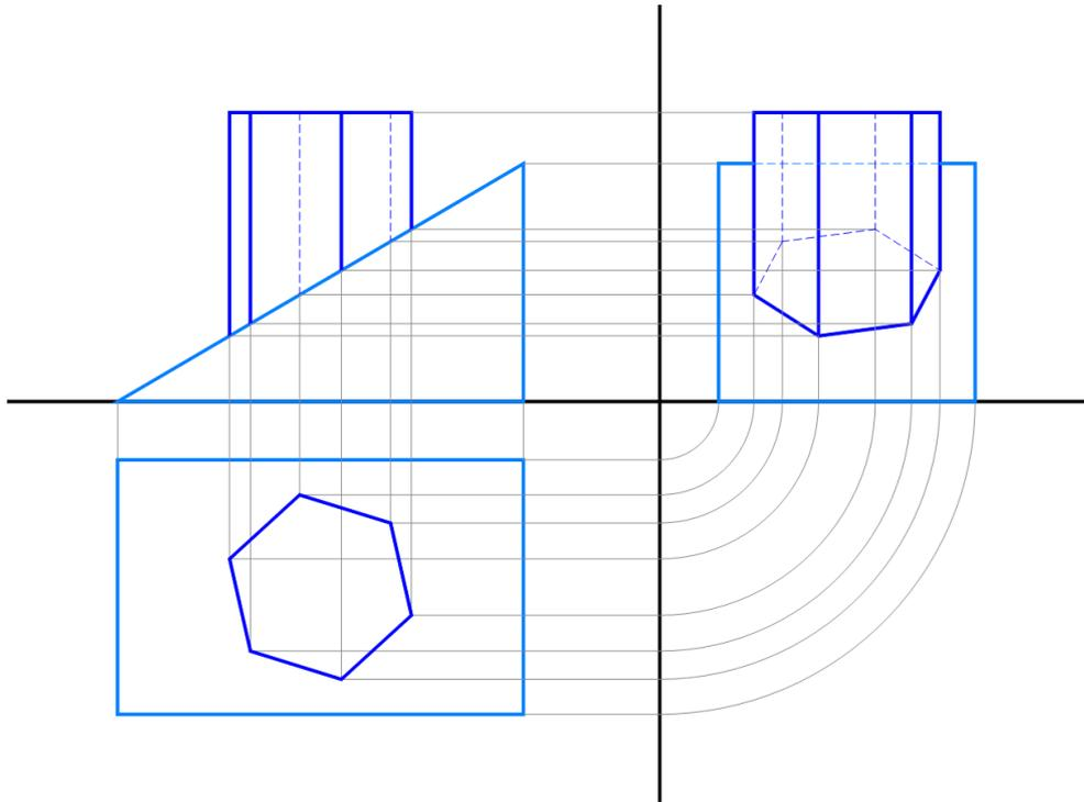
**Compenetrazione di un prisma a base esagonale parallele al piano orizzontale e un prisma a base triangolare con una faccia laterale appoggiata al piano orizzontale.**
