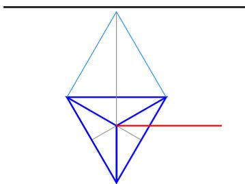
Con raggio uguale all'altezza del triangolo ribaltato, riportare l'arco fino ad intercettare la retta passante per il vertice del tetraedro e individuare l'altezza oggettiva del solido ribaltata sul piano orizzontale. Proiettare sul piano verticale e riportare la misura con un arco avente come centro l'intersezione della proiezione del vertice con la linea di terra. Individuato il vertice unire ai tre vertici di base per completare la proiezione.
