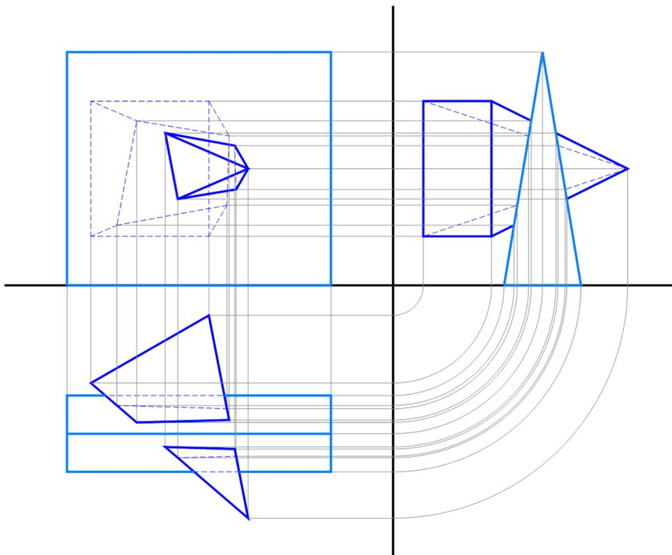
**Compenetrazione di una piramide a base rettangolare con asse parallelo al piano orizzontale e un prisma a base triangolare con una faccia laterale appoggiata al piano orizzontale.**
