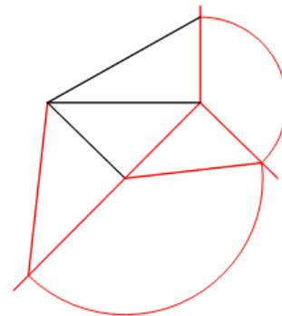
Si procede quindi alla proiezione in vera forma e grandezza della base ABC coincidente con il piano  $\alpha$  ribaltato. La posizione della base, se non diversamente specificato, sarà generica. L'unica condizione a cui bisogna attenersi è che tale proiezione sia completamente all'interno della superficie delimitata da  $T^I\alpha$ ,  $T^I\beta$  e dalla  $T^{II}\alpha^*$ .
