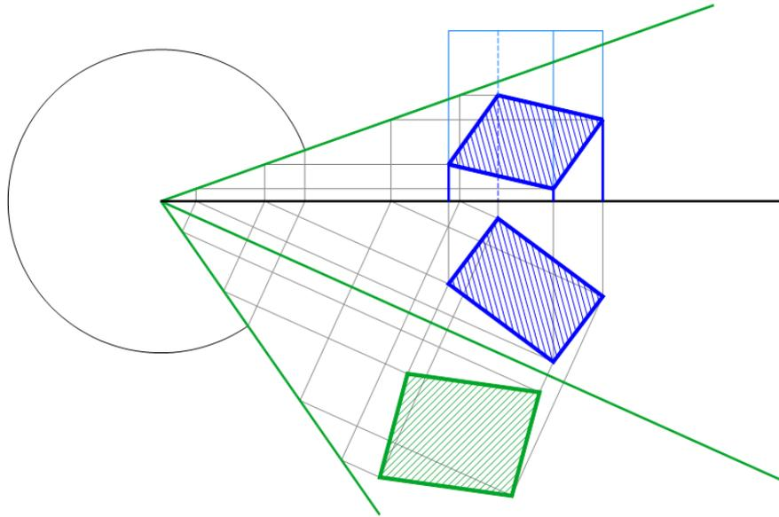
Sezione di un parallelepipedo determinata da un piano secante genericamente inclinato
