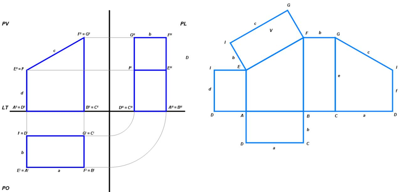
Proiezioni ortogonali e sviluppo di un parallelepipedo sezionato da un piano inclinato
