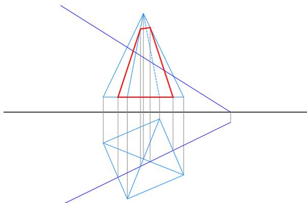
Sfruttando le condizioni d'appartenenza fra retta e piano, impostiamo un piano secante ausiliario ortogonale al piano orizzontale passante per la retta  $r$ . Procedere definendo il contorno della sezione sulla piramide e individuando i punti di contatto con la sezione. Poiché la sezione è per costruzione complanare rispetto alla retta  $r$ , gli eventuali punti di contatto, sul piano verticale, fra la sezione della piramide e la retta individuano i punti di intersezione fra le due figure.
