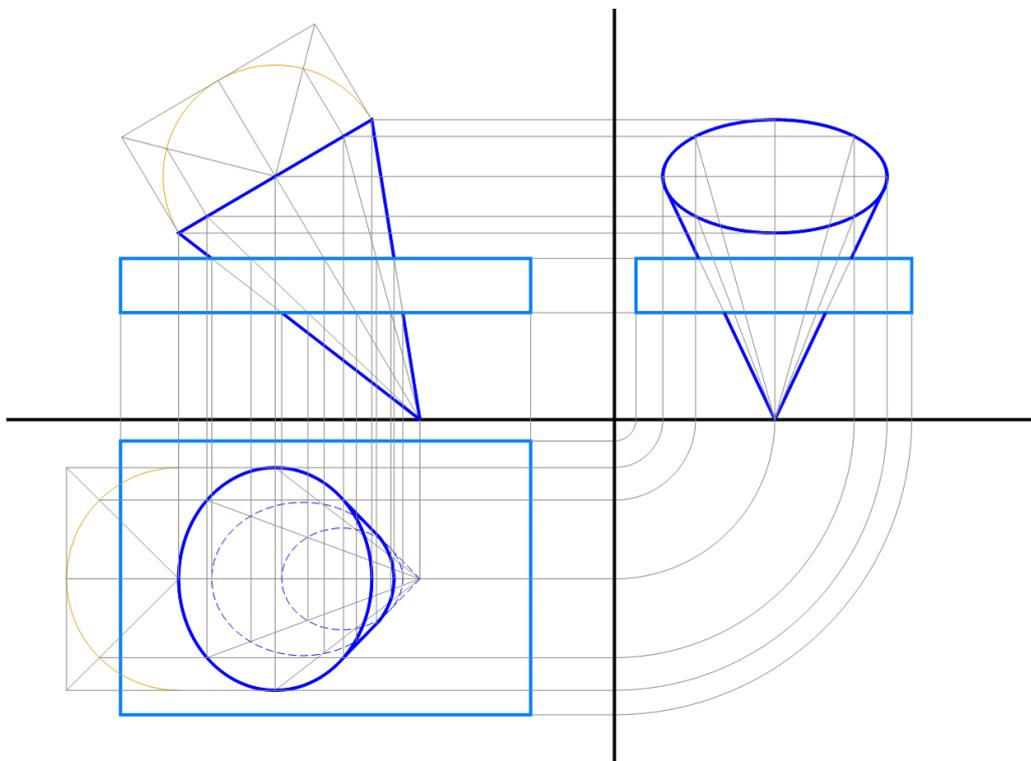
**Compenetrazione di un cono con asse inclinato rispetto al piano orizzontale e un parallelepipedo con le facce parallele ai piani principali**
