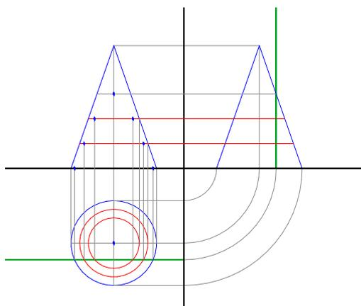
Unire con una curva i punti di sezione individuati e rappresentare l'iperbole. La curva sarà tanto più attendibile quanto più saranno i piani ausiliari paralleli alla base utilizzati per determinare i punti di sezione. Fra le sezioni coniche l'iperbole è l'unica, oltre al cerchio, che non ha necessità di essere proiettata su un piano ausiliario per poter essere rappresentata in vera forma e grandezza poiché il piano secante è, in questo caso, parallelo al piano verticale.
