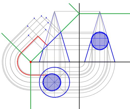
Per capire esattamente la tipologia della sezione sarà necessario, per mezzo del ribaltamento del piano secante sul piano verticale determinare la superficie di sezione in vera forma e grandezza. Dal ribaltamento si evince che data la posizione del piano secante rispetto al cono il luogo geometrico della curva chiusa di sezione è un'ellisse.
