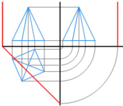
Data la piramide a base quadrata, parallela al piano orizzontale e ruotata rispetto ai piani verticale e laterale, determiniamo una sezione generata da un piano secante  $\alpha$  ortogonale al piano orizzontale e inclinato rispetto ai piani verticale e laterale.
