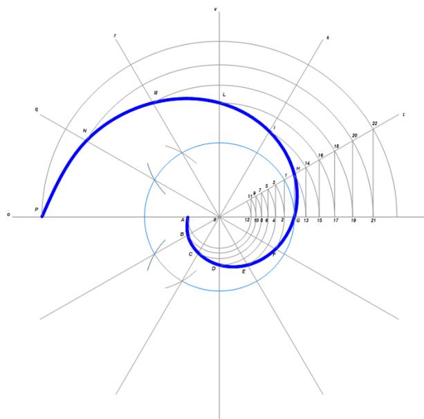
Tracciare gli assi orizzontale (o), verticale (v) e determinare nell'intersezione il punto O.
