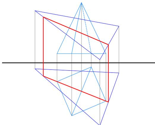
Determinare la sezione del triangolo con un piano secante ortogonale al piano orizzontale passante per gli spigoli AV e CV della piramide.
