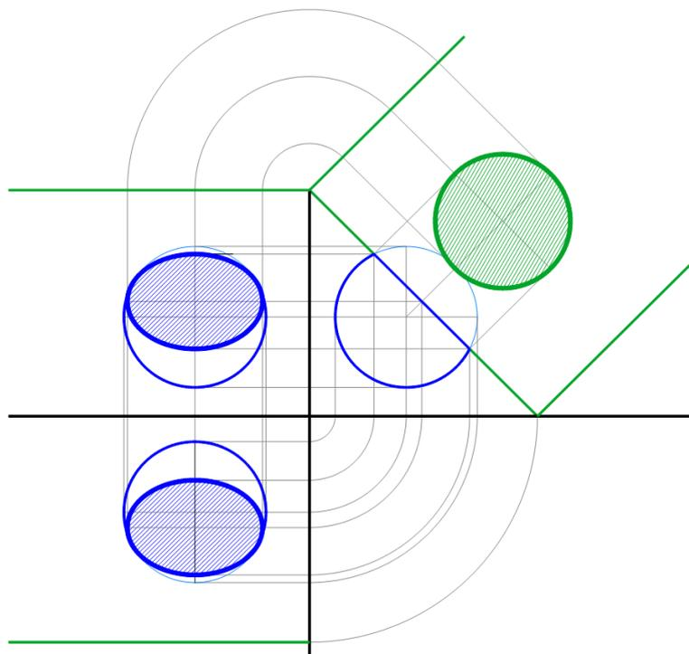
**Sezione di una sfera, con un piano secante ortogonale al piano laterale e inclinato rispetto ai piani orizzontale e verticale.**
