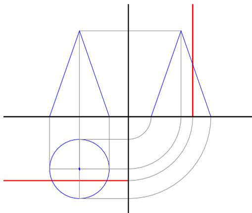
La sezione di un cono determinata da un piano secante  $\alpha$  parallelo a due generatrici, AV e CV nel caso in oggetto, inclinato rispetto a tutte le altre, determina un'iperbole. Nella realtà l'iperbole è la sezione di due coni sovrapposti, falda inferiore e falda superiore, con vertice V in comune e asse appartenente alla stessa retta. Nella proiezione ortogonale, per semplicità, viene proiettata la sola sezione determinata nella falda inferiore.
