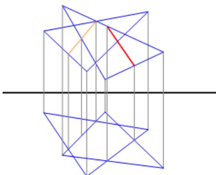
Procederemo con le stesse modalità operative per determinare la sezione sul triangolo DEF, generata dal piano secante ortogonale al piano orizzontale passante per il lato BC.
