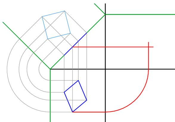
Intercettare sul piano laterale i raggi proiettanti ortogonali provenienti dal piano orizzontale e dal piano verticale. Sul terzo piano di proiezione, unendo i punti consecutivi, si determina la proiezione del quadrilatero ABCD.
