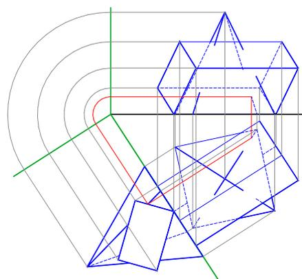
*La proiezione ortogonale, compenetrazione di due o più solidi, è data dalla determinazione dei punti e delle linee di intersezione individuate dopo aver rappresentato i solidi elementari che lo costituiscono.*
