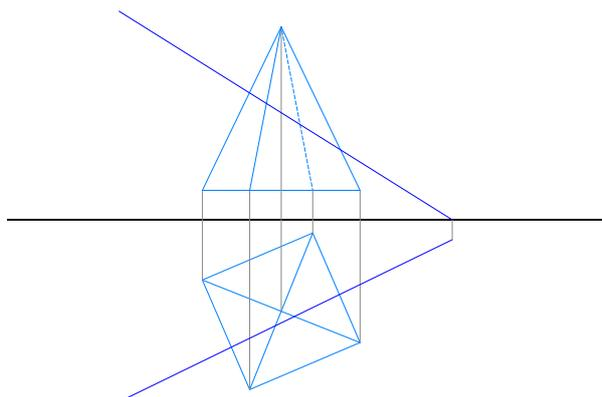
Dopo avere tracciato una piramide a base quadrata genericamente ruotata rispetto al piano verticale e una retta  $r$  genericamente inclinata, le cui proiezioni risultano sovrapposte, cerchiamo di verificare se si determinano punti d'intersezione fra le due figure. Nell'esempio in oggetto è definita la rappresentazione di un'unica traccia sul piano orizzontale.
