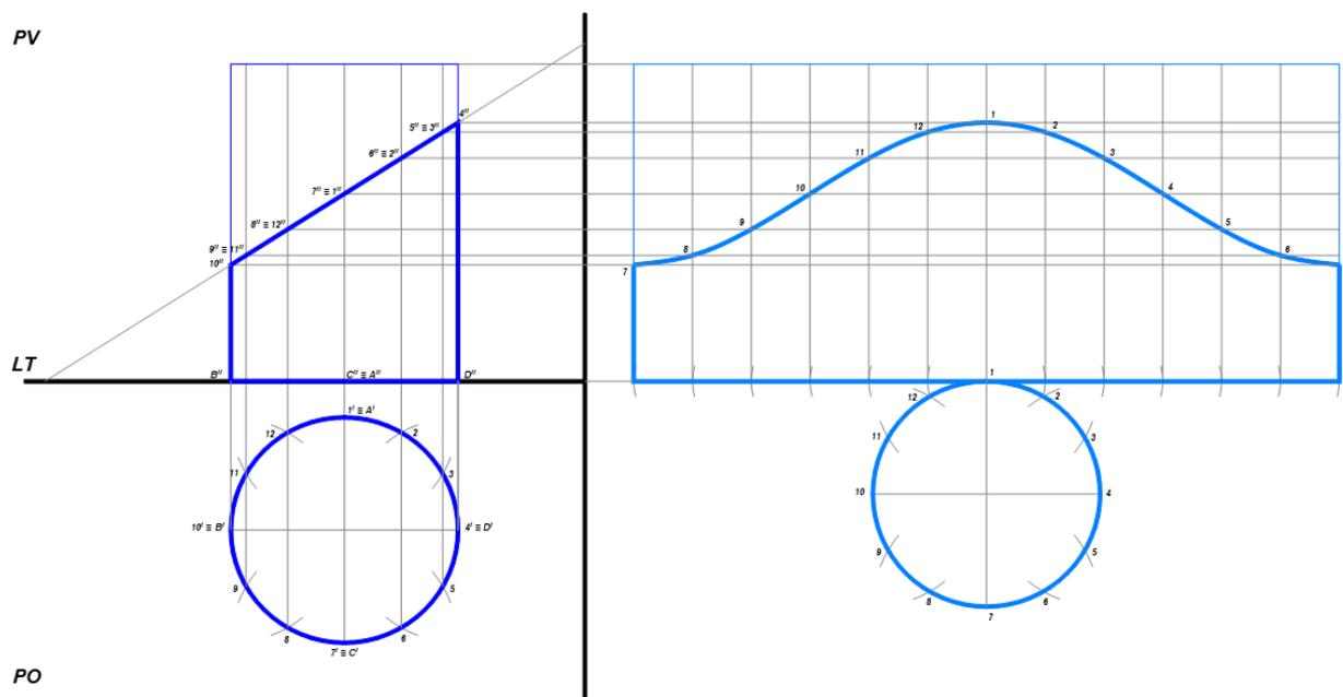
Proiezioni ortogonali e sviluppo di un cilindro retto sezionato da un piano inclinato
